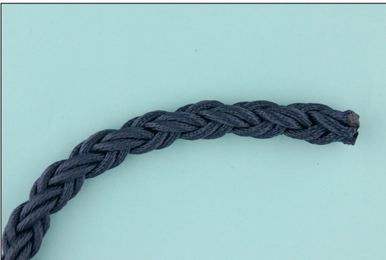
Achtstrengslijn. Bestaat uit twee paar rechtsom en twee paar linksom gedraaide strengen. De rechtsom gedraaide strengen zijn soms gemarkeerd met een controlelijn. Oogsplits: H2, p. 29
