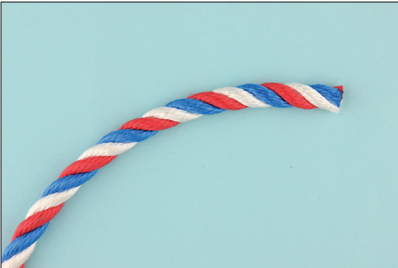
Driestrengslijn. Gemaakt van drie strengen die om elkaar zijn geslagen. Oogsplits: H1, p. 25
