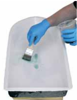
6. Na uitharden gelcoat wordt polyesterhars aangebracht.
