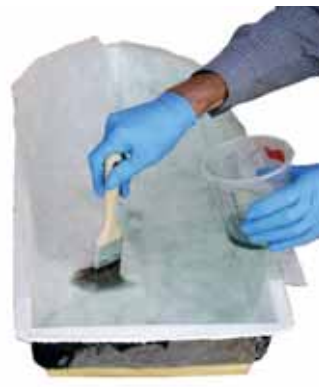
8. De glasmat wordt geïmpregneerd met polyesterhars.
