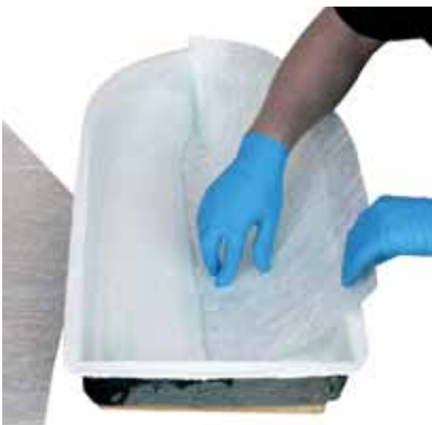
7. Glasmat wordt in de natte hars gelegd.
