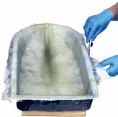
10. Als de hars is gegeleerd wordt het overtollige materiaal afgesneden.
