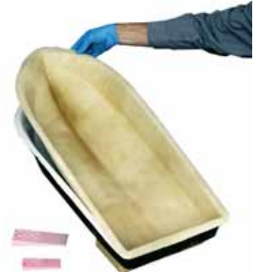
12. Het vormstuk kan uit de mal worden gehaald.
